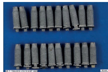
Čepy S-BT vytažené po dvanáctitýdenní cyklické korozní zkoušce podle EN ISO 16701. Není viditelná žádná koroze.
