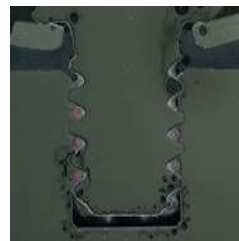
Mechanismus upevnění čepu S-BT v oceli
