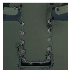
Leštěný řez: aktivované zapouzdřené lepidlo na samořezném závitě upevňovacího prvku S-BT
