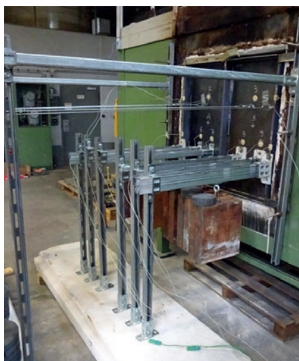
Obrázek 2: Zkušební zařízení pro požární zkoušku (malá přepážka)
