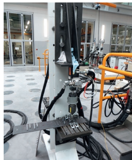
Uspořádání zkoušek cyklického tahového zatěžování
