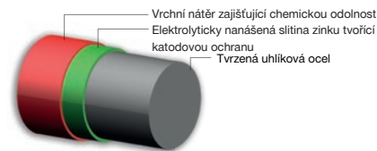
Duplexní povlak upevňovacích prvků S-BT z uhlíkové oceli
