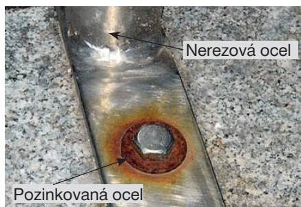
Korozní potenciál různých kovů v mořské vodě
