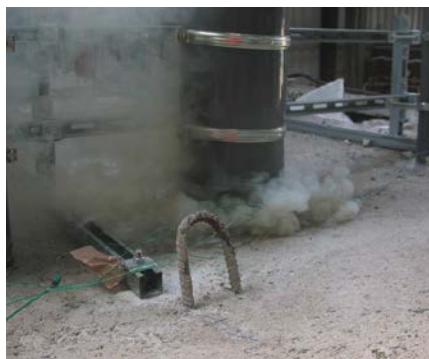
Kouř unikající z neadekvátně utěsněného plastového potrubí v průběhu požárního testu po pouhých 8 minutách
